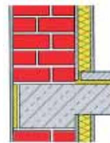
Abb. 16 Außendämmung U-Wert*: 0,46 \text{ W}/(\text{m}^2\text{K}) Einsparung: 69%
