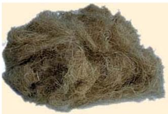
Bereich des Eindeckrahmens um Kondenswasserschäden vorzubeugen. Stopfhanf besteht aus reinen mechanisch aufbereiteten Hanffasern, die mit 3-5% Soda imprägniert sind. Die Verarbeitung ist einfach und kann je nach Bedarf dicht oder locker sein.
