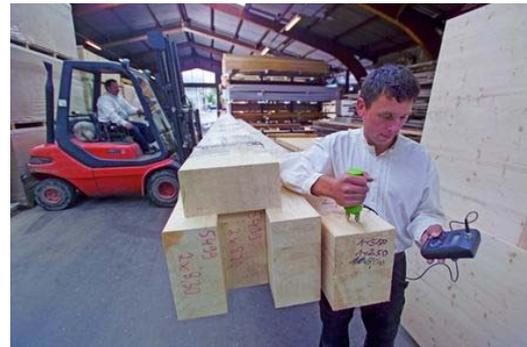
Es wird nur hochwertiges Bauholz verwendet, das vor der Verarbeitung auf seine Holzfeuchte hin überprüft wird.
