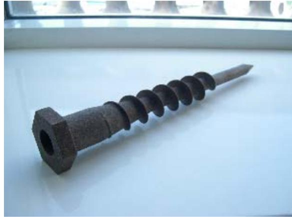
TREEPLAST vereinigt als Biokunststoff die Vorteile von nachwachsenden Rohstoffen mit denen der modernen Kunststoffverarbeitung, wie dem Spritzguss. Die unterschiedlichsten biogenen Materialien können in diesem Verfahren zu Serienprodukten verarbeitet werden und sind wie Holz weiterverarbeitbar. Die Verwendung dieses Biokunststoffs erlaubt einen problemlosen Rückbau und die Rückführung in den biologischen Kreislauf.
