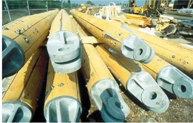
Rundholzstützen mit Gelenkformteilen
