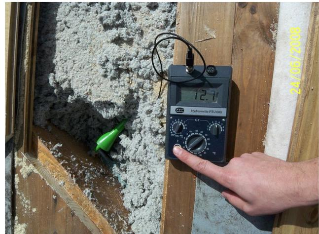
**Abb. 10: unbelüftetes Flachdach mit Begrünung, wegen Zellulose-Dämmung trotzdem deutlich unter 20 Prozent Holzfeuchte**
