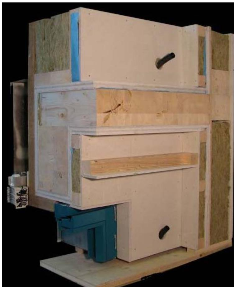
**Abb. 9: Mock up – Gekapselte Holzkonstruktion mit Brettstapeldecke**
