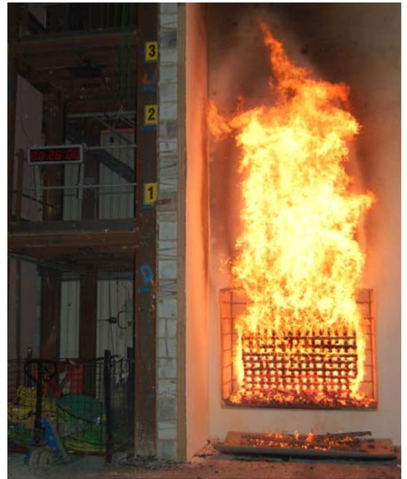
**Abb. 6: Grossbrandversuch mit Holzweichfaserplatten nach 26 Minuten Prüfdauer**
