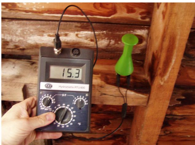
**Abb. 7: Robust: Trotz langjähriger Undichtigkeiten keine erhöhte Holzfeuchte – wenn es immer wieder austrocknen kann**
