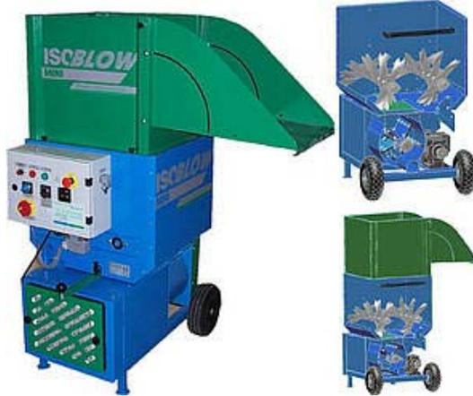
Die ISOblow Mini ist eine sehr kompakte Einblasmaschine zum Verarbeiten von Zellulosedämmstoff sowie sonstige zugelassene lose und rieselfähige Dämmstoffe. Die Beschickung erfolgt über die Einfüllklappe. Für den Transport kann der Aufsatz durch Entfernen von 4 Sterngriffschrauben abgenommen werden. Zwei Häckslerwellen im unteren Bereich des Vorratsbehälters sorgen für eine sehr gute Auflockerung der Zellulose.
