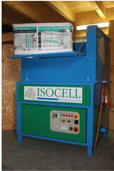
ISOblow Profi ist eine extrem leistungsstarke Einblasmaschine für den Profi - Anwender. Material und Luftmenge sind über Bedienelemente regulierbar. Durch den großen Vorratsbehälter (120 x 90 cm) ist es möglich, die Maschine der Breite nach zu befüllen.
