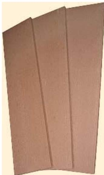
Die ProCrea®-Lehm-Platte ist eine kompakte Trockenbauplatte für den Innenbereich. Sie ist Putzträger, Speichermasse und Installationsebene in einem. Für den Fußboden gibt es die Hock-Lehm-Platte 50. Hergestellt wird die ProCrea®-Lehm-Platte aus Lehm mit Zusatz von Sägespänen.
