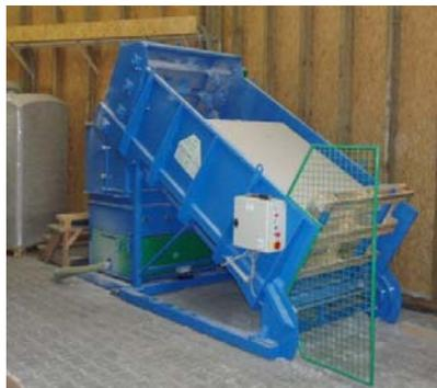
Die ISOblow – Großballenanlage dient zur industriellen Vorfertigung in der Halle. Als Grundgerät dient die ISOblow – Profi – Einblasmaschine. Es werden bei dieser Anlage nicht die üblichen 12,5 kg. Säcke von ISOCELL verarbeitet, sondern BIG – BAG's mit ca. 280 kg.
