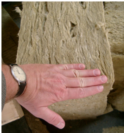
Dämmstoff mit der Wärmeleitfähigkeit von 0,035 \text{ W/(mK)} auswählen
