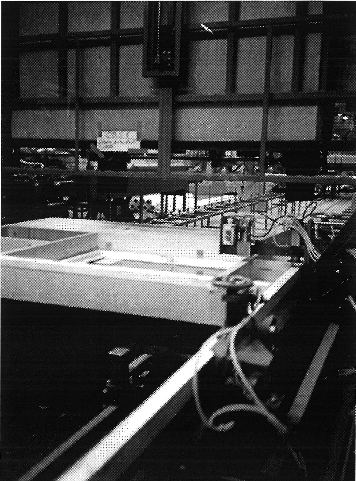
Abb. 28: Vorfertigung eines Wandelements
