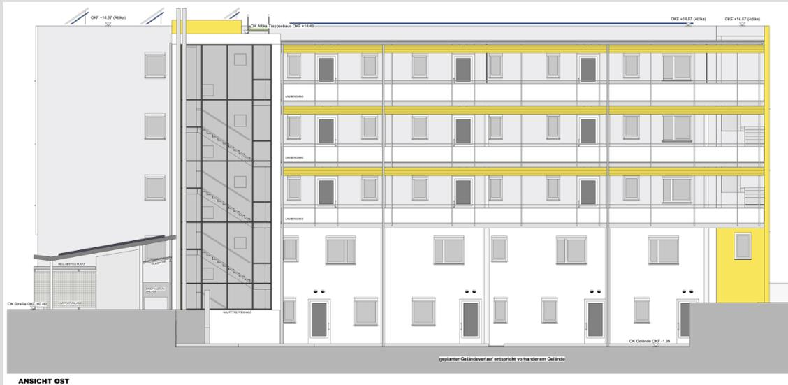
**Bild 5:** Ansicht Ostseite, Erschließung des Gebäudes über Laubengänge (Quelle: faktor10)
