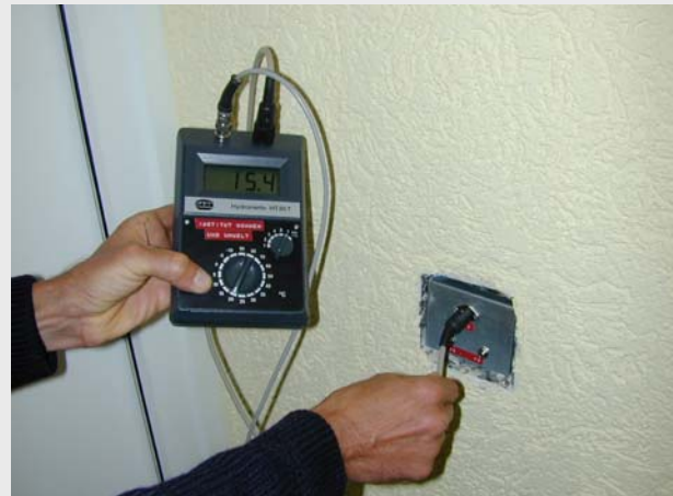
Bild 38: Probemessungen für Feuchte (links) und Temperatur (rechts)
