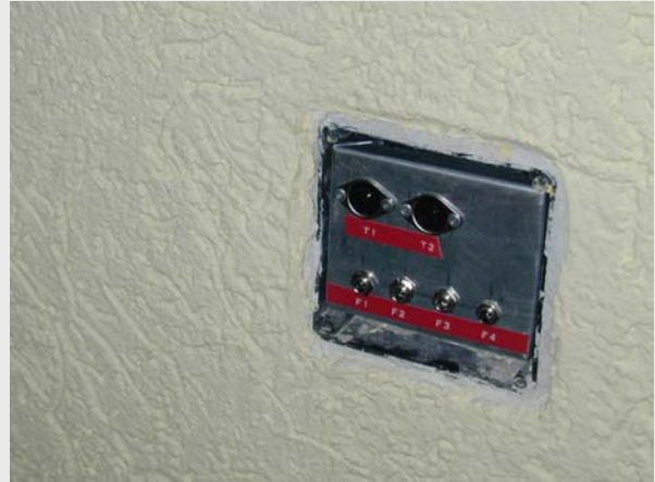
Bild 38: Probemessungen für Feuchte (links) und Temperatur (rechts)
