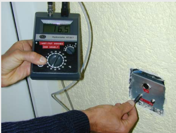
Bild 38: Probemessungen für Feuchte (links) und Temperatur (rechts)
