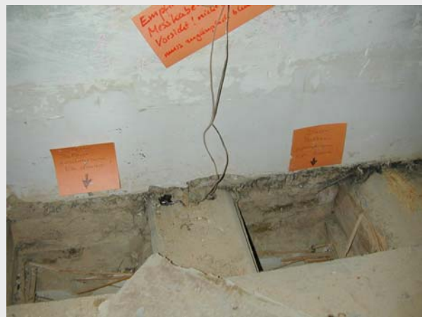
Bild 32: Linkes Bild: Vorbereitung einer Temperatursonde zur Installation neben einem bereits fertigen Sondenpaar zur Feuchtemessung (Messstelle 2 bzw. 6) Rechtes Bild: Fertig installierte und abgedichtete Temperatursonde im Bohrloch (links) neben Sondenpaar zur Feuchtemessung (rechts) an Messstelle 1. Da die Installation der Messtechnik sich über mehrere Termine hinzog und an den Fortgang der Sanierungsmaßnahmen angepasst werden musste, wurden Schilder zur Information der Handwerker angebracht, die auf dem Photo ebenfalls erkennbar sind.
