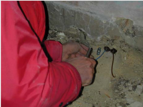
Bild 32: Linkes Bild: Vorbereitung einer Temperatursonde zur Installation neben einem bereits fertigen Sondenpaar zur Feuchtemessung (Messstelle 2 bzw. 6) Rechtes Bild: Fertig installierte und abgedichtete Temperatursonde im Bohrloch (links) neben Sondenpaar zur Feuchtemessung (rechts) an Messstelle 1. Da die Installation der Messtechnik sich über mehrere Termine hinzog und an den Fortgang der Sanierungsmaßnahmen angepasst werden musste, wurden Schilder zur Information der Handwerker angebracht, die auf dem Photo ebenfalls erkennbar sind.
