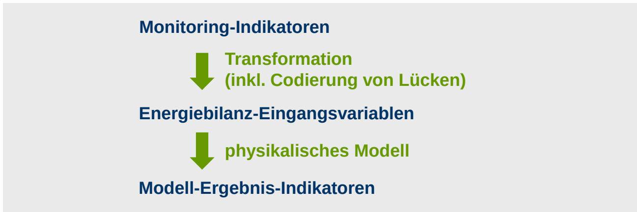
Bild 4: Schema für das zweistufige Vorgehen bei der energetischen Bilanzierung auf der Basis von Monitoring-Indikatoren (Energieprofil-Variablen)
