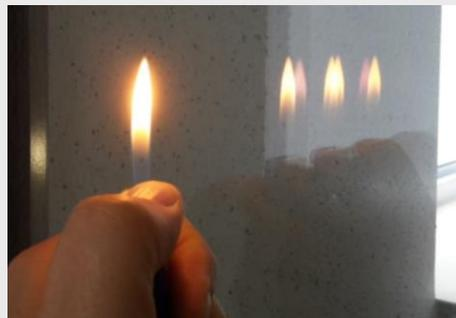
Optische Feuerzeugprobe bei der Dreifach-Verglasung im Treppenhaus: Die Reflexe der Ebenen 2 und 5 (von 6) sind rötlich, was jeweils auf eine Beschichtung hindeutet (Wärmeschutzverglasung)
