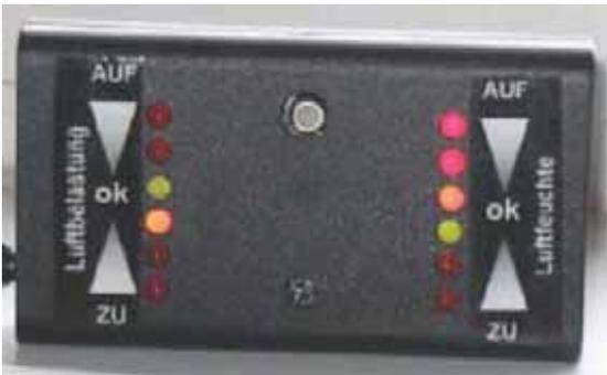
**Abbildung 1.5-3: Lüftungsampel [UTECH]**
