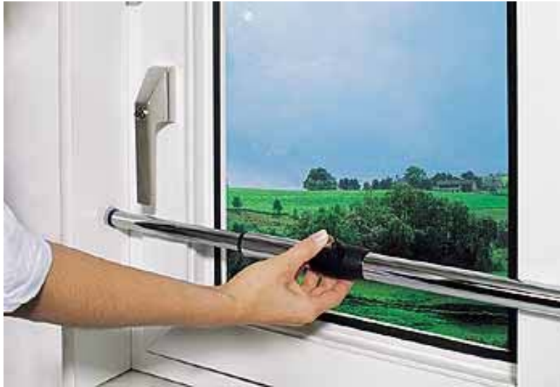
Abbildung 8 Sicherung eines Fensterflügels gegen Aufdrücken im gekippten Zustand durch eine beiderseitig in der Laibung befestigte Querstange (Quelle: ABUS)
