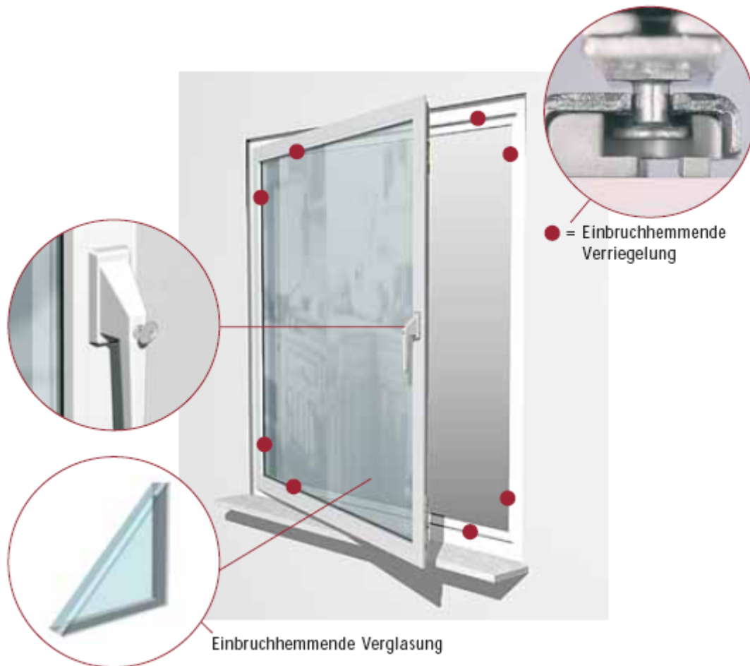
Abbildung 7 Gesamtkonstruktion einbruchhemmender Fenster (Quelle: [ZGPK 2009])
