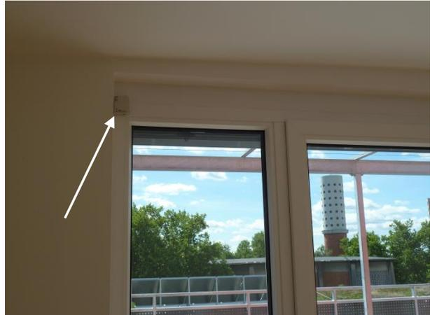
**Abb. 2-3:** In den Dachgeschosswohnungen wurde ein Datenlogger zusätzlich im Wohnzimmer am Fensterahmen befestigt
