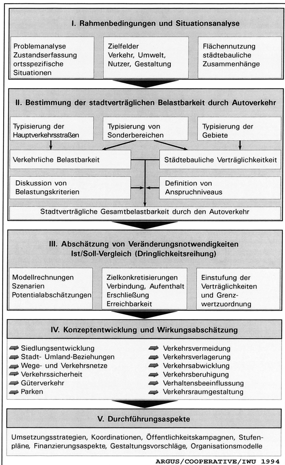
Bild 7.2-1: Struktur einer erweiterten VEP/SVP
